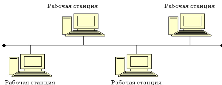
Рисунок 13. Сеть с шинной топологией
